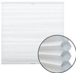
Stoff 100 % Polyestervlies, blickdicht, 20 mm Wabe, energiesparend, schallabsorbierend, im Sommer wärmeabweisend, individuell höhenverstellbar über 2 Bedienschiene aus Aluminium, inkl. 2 Bediengriffen und 4 Kunststoff-Klemmträgern zur einfachen Montage an den Fensterflügel (Verstellbereich ca. 10-25 mm), verspanntes Plissee zur Fixierung auch bei gekipptem Fenster
