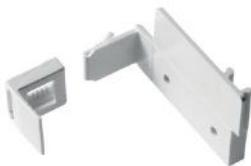
Kunststoff, einfache Montage an den Fensterflügel ohne Bohren und Schrauben, Klemmträger verstellbar, Verstellbereich: 15-22 mm, durch Abknicken des Klemmwinkels kann der Klemmträger auch als Klebträger genutzt werden
