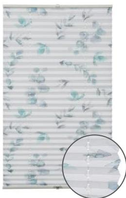
Stoff 100 % Polyester, lichtdurchlässig, blickdicht, 20 mm Plisseefalte, Montage ohne Bohren und Schrauben, individuell höhenverstellbar über 2 Bedienschienen aus Aluminium, inkl. 2 Bediengriffen und 4 Klemmträgern (Verstellbereich ca. 12-23 mm), verspanntes Plissee zur Fixierung auch bei gekipptem Fenster, einfach in der Breite kürzbar, 100 % kindersicher nach EN 13120
