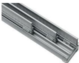
Aluminium, 3-läufige Schiene, mit Endstücken, komplett mit Paneelwagen inkl. Klettband, Beschwerungsprofile mit Endkappen, Mitnehmer für Paneelwagen, Träger für Wand- und Deckenmontage und Aluminiumschleuderstab 100 cm, inkl. Befestigungsmaterial Länge der Paneelwagen und Beschwerungsprofile = 60 cm
