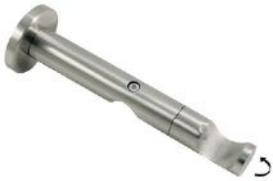
Metall, drehbar, vorderer Lauf für Gardinenstange Ø 25 mm, hinterer Lauf für Gardinenstange Ø 20 mm oder für Gardinenstange mit Innenlauf Ø 20 mm (Sortiment Chicago), mit Metallmontageplatte, inkl. Befestigungsmaterial, Trägerlänge (Wandabstand der Gardinenstangen) 8 cm und 14,5 cm
