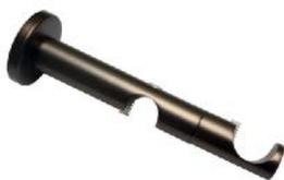
Metall, drehbar, vorderer Lauf für Gardinenstange Ø 25 mm, hinterer Lauf für Gardinenstange Ø 20 mm oder für Gardinenstange mit Innenlauf Ø 20 mm (Sortiment Chicago), mit Metallmontageplatte, inkl. Befestigungsmaterial, Trägerlänge (Wandabstand der Gardinenstangen) 8 cm und 14,5 cm
