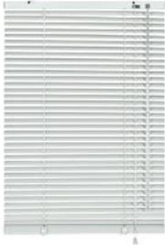
25 mm Aluminium-Lamellen, Stahl-Oberschiene 25 x 25 mm, Jalousiebänder farblich passend, Bedienung mittels Schnurzug und Wendestab rechts, inkl. Befestigungsmaterial für Decken- oder Wandmontage, 100 % kinder-sicher nach EN 13120
