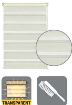
Stoff 100 % Polyester, segmentweise gewebter Stoff für verstellbare Lichtdosierung, Mini Rollowelle ø 18 mm, Kleben oder Klemmen für einfache Montage auf dem Fensterflügel, Klemmträger verstellbar (15-22 mm), Schraubmontage möglich, Seitenzuggetriebe wahlweise rechts oder links montierbar
